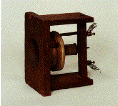
Bellovo zařízení podle patentu (1876) (obr. převzat ze stránky http://park.org/Japan/NTT/MUSEUM/html_f2/F2_10101_e.html )
