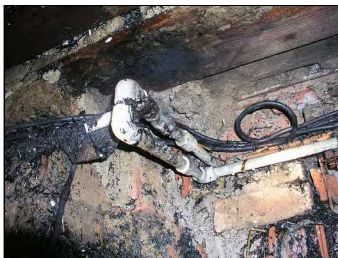
Obr.: Ohřev tohoto plastového vodovodního potrubí PB hořákem měl za následek požár rodinného domu.
