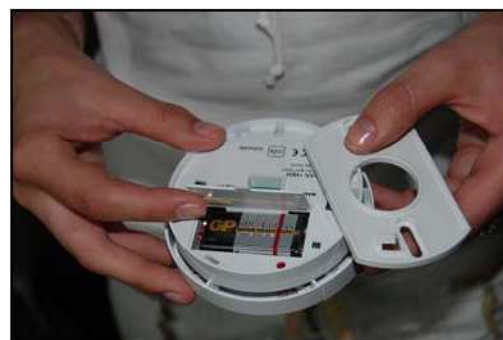
Obr.: Autonomní hlásič kouře (detail) – napájení baterií
